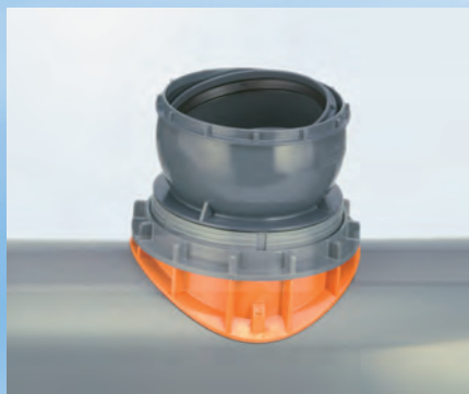
Raccord de piquage CONNEX DN/OD 160/200 sur un tube CONNEX, perçage 200 ± 1 mm
